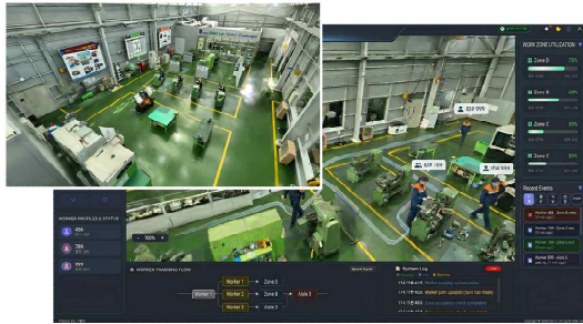
그림 4. 웹 기반 초실감 3D 통합 모니터링
