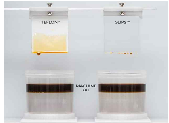
[그림3] 일반적인 불소계 코팅(Teflon) 대비 오일 배척 및 자가복원 성능이 탁월한 SLIPS 표면 비교 (Source:AST)
