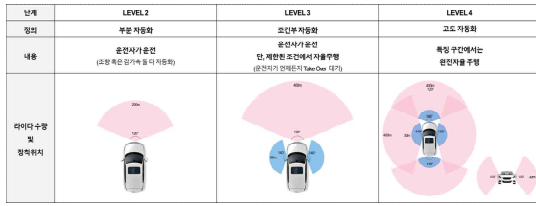
<그림 2> 자율주행차 기술단계별 라이다 장착 위치
