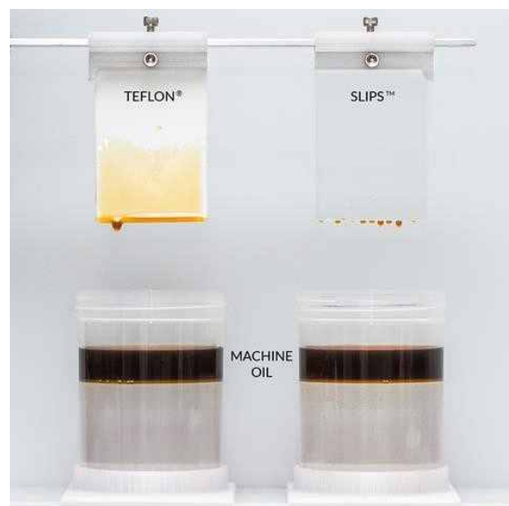
Fig. 3 일반적인 불소계 코팅(Teflon) 대비 오일 배척 및 자가 복원 성능이 탁월한 SLIPS의 표면 비교 (from ©AST)
