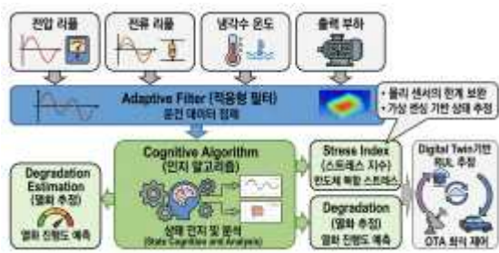
Fig. 3 가상 인지 센서 구조도
