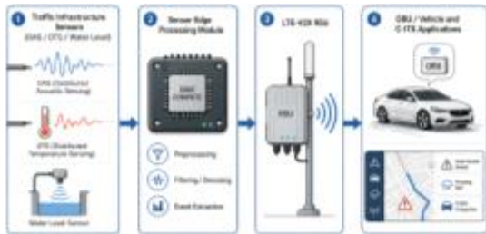
Fig. 1 엣지 컴퓨팅 기반 C-V2X RSU 시스템 구조
