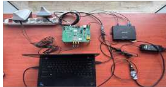
Fig. 3 LTE-V2X RSU와 OBU를 이용한 데이터 전송지연 측정 시험 셋팅
