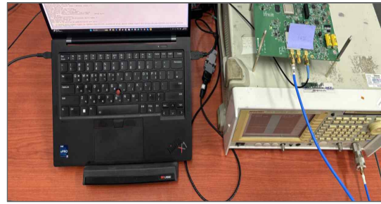
Fig. 2 Spectrum Analyzer를 이용한 RSU 전송 주파수 측정 시험 셋팅
